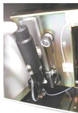
Foto 30 Zatlačte píst dolů, dokud nebude kovová spona nad hliníkovým hákem, a poté píst uvolněte.
