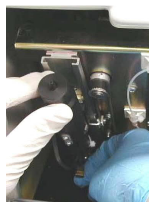
Foto 27 Zatlačte píst dolů a jedním prstem druhé ruky vytáhněte přídržnou sponu. Vyměňte píst úplně. Dávejte pozor na špičku jehly, která vyjde z horní části pístu!
