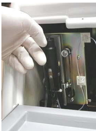
Foto 31 Zatlačte na sestavu pístu, dokud magnety píst udrží
