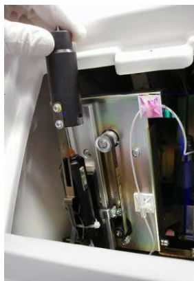
Foto 29 Vložte píst při pohledu na jeho kovovou sponu, která musí spadnout před vás
