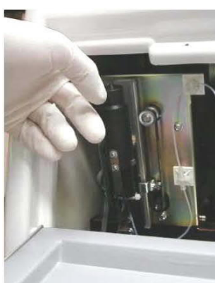
Foto 26 Pevně zatáhněte sestavu pístu směrem k sobě, aby jistící magnety uvolnily sestavu.
